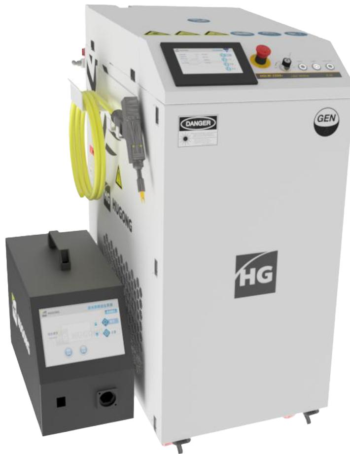
Machine de soudage semi-automatique laser à trois en un.
